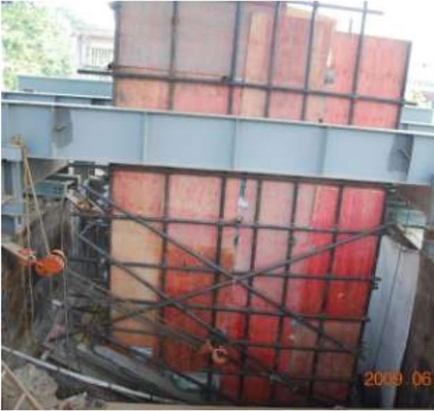
图 27 复合衬垫大型斜坡模型试验
