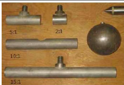
图9 各种 T-BAR 测试探头
